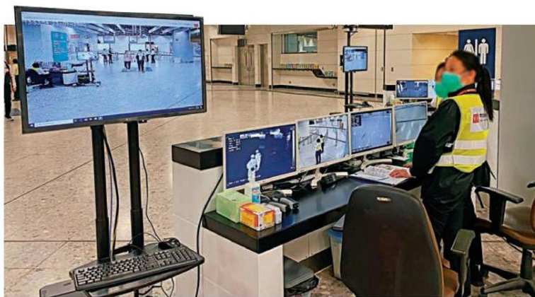
▲科大研發的「智能發燒偵測系統」，已在邊境口岸設置，幫助防疫。
